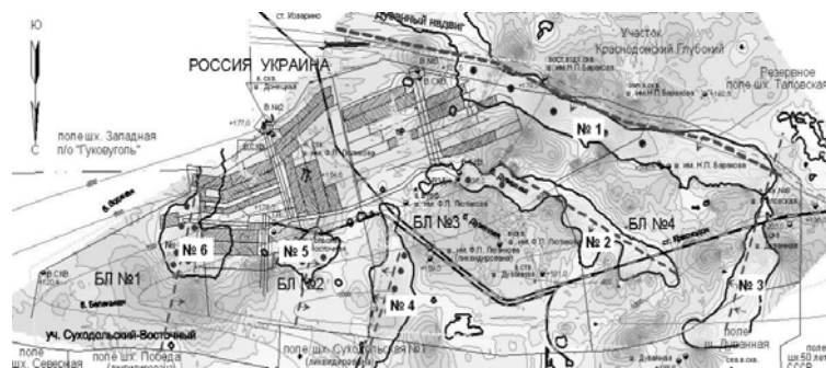
Рис. 1 – Карта зон сосредоточения метана в газовых ловушках в пределах поля шахты «Суходольская – Восточная»
